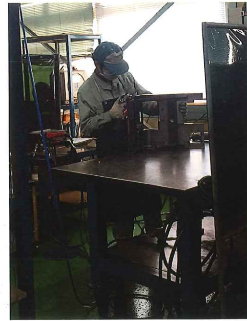
<カバー溶接組立/仕上げ>
